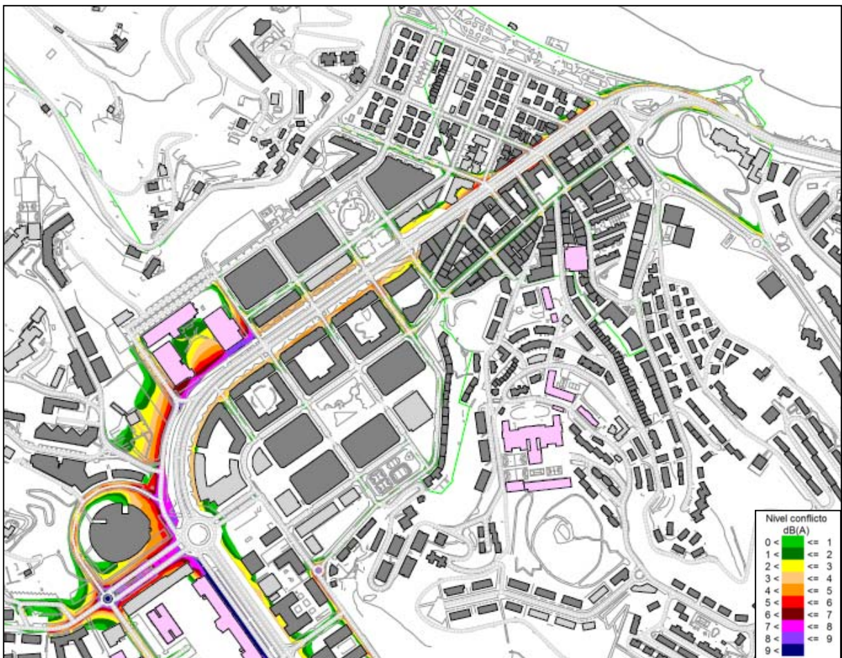
Exceso de dB(A) por encima de los OCA establecidos a 2m.
